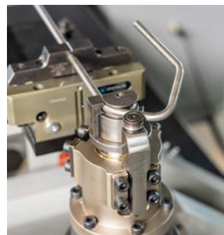
▲ Standardbiegewerkzeug kombiniert Zug- und Rollbiegen
